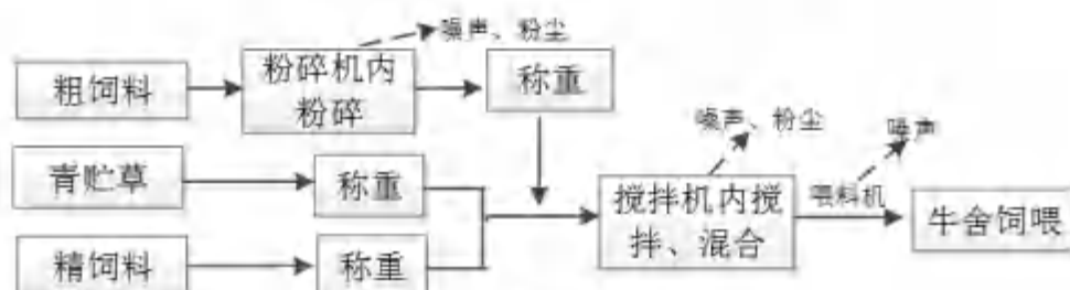
图 3.2.3-3 饲料加工流程
